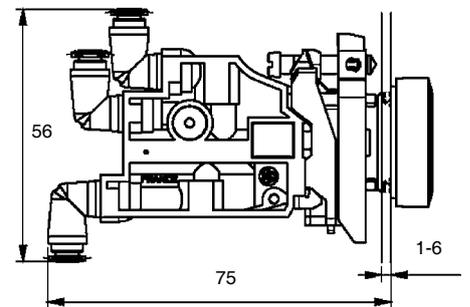
**Assemblage des vannes PXB-B3. et PXB-B4. sur le support de montage**
