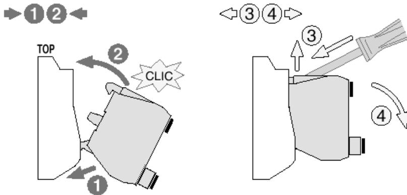
**Assemblage des vannes PXB-B3. et PXB-B4. à l'arrière d'un bloc électrique**
