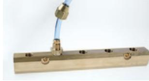
Mettre le tube en butée contre l'épaulement du corps du raccord et pré-visser à la main.
