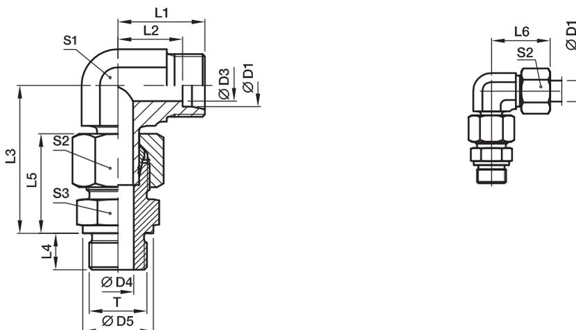
Pré-assemblé, avec union mâle orientable (à étanchéité métallique).
