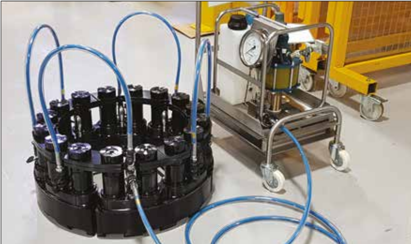
▲ Installation de la mise en tension multigoujon.
