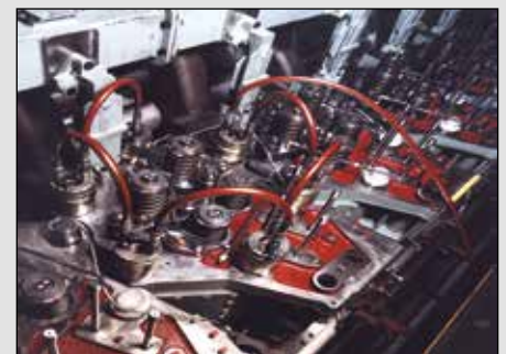
▲ Écrous hydrauliques sur moteur diesel
