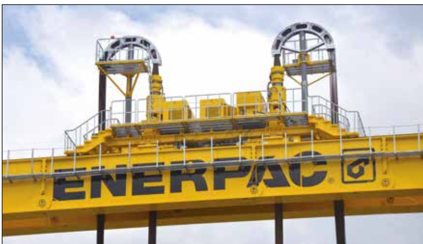
▼ Système de levage lourd par vérins à câbles HSL85007 utilisé sur tour autoérectile Enerpac personnalisée.
